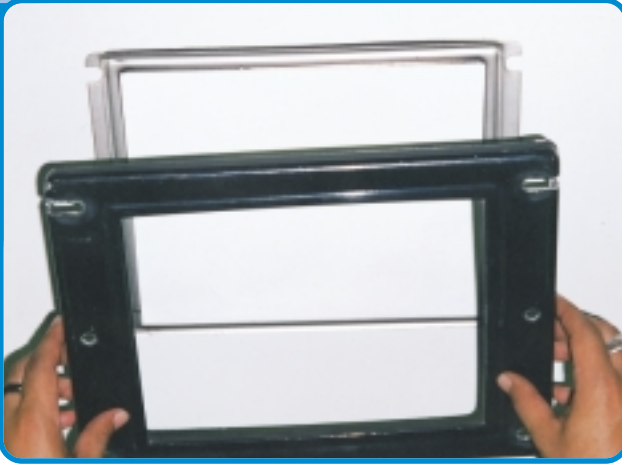
ภาพที่ 22 การวางกระดาษกรองในเครื่องเก็บตัวอย่างอากาศชนิดไฮโวลูม
