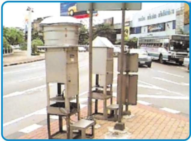
ภาพที่ 23 เครื่องเก็บตัวอย่าง PM 10 ชนิดไฮโดรลูม
