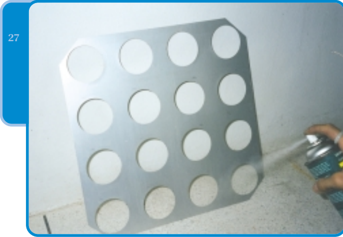
ภาพที่ 27 การพ่น Silicone Grease บนแผ่นดักฝุ่นละอองขนาดใหญ่กว่า 10 ไมครอน
