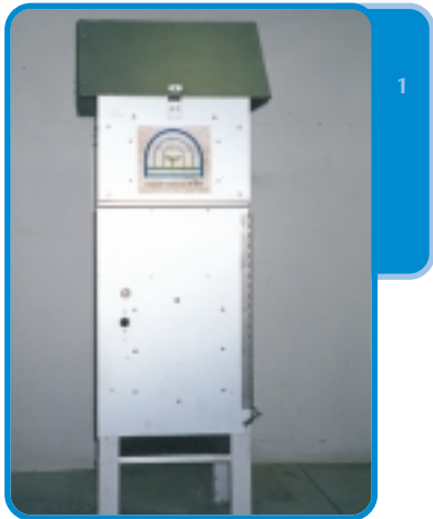
ภาพที่ 1 เครื่องเก็บตัวอย่าง TSP ชนิดไฮโดลม
