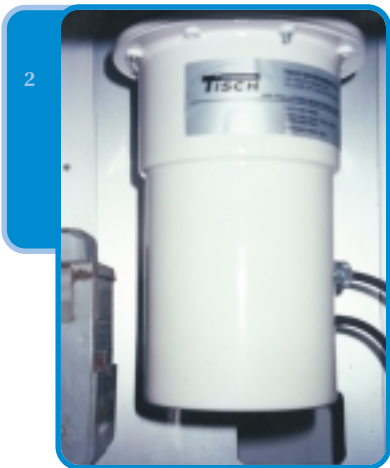
ภาพที่ 2 มอเตอร์สำหรับดูดอากาศให้ไหลผ่านกระดาษกรอง
